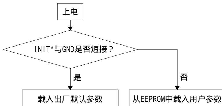
图4 IR-1327AP 启动过程及参数载入流程图
